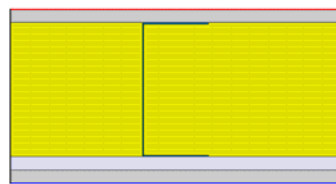
شکل ۴-۵- مقطع دیوار با عایق تکمیلی ۱ سانتی‌متری
